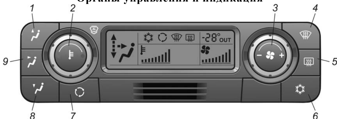
Рис. 8.1. Пульт управления отопительно-вентиляционной и климатической установкой
