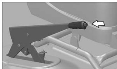
Рис. 5.8. Рычаг стояночного тормоза
