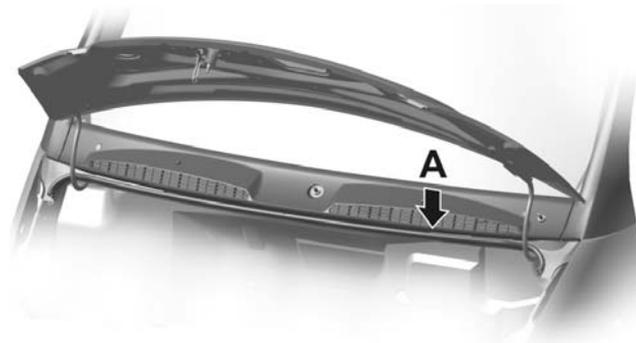
Рис. 1.2. А – место нанесения идентификационного номера кабины
